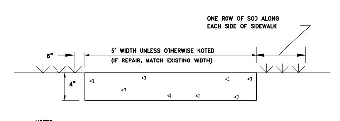
CONCRETE SHALL BE 2,500 PSI, MAX SLUMP 5" SAWCUT CONTROL JOINTS AT SPACING EQUAL TO WIDTH OF SIDEWALK INSTALL EXPANSION JOINT AT EVERY FOURTH CONTROL JOINT (25' MAX) SIDEWALK TO HAVE BROOM FINISH WITH A 4" TROWELED EDGE.
